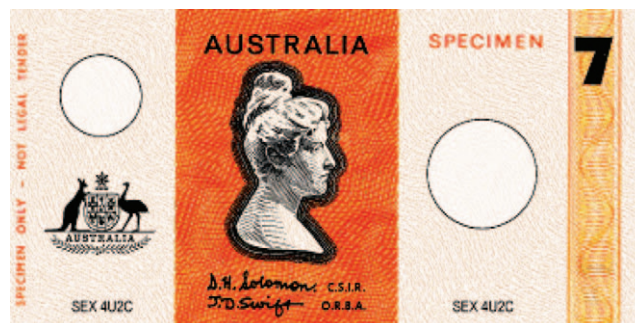
Abbildung 10. Versuchsbanknote mit dem Nennwert $7, gedruckt auf Strand 75 und mit zwei ausgeschnittenen Löchern für den Einbau von OVDs.
