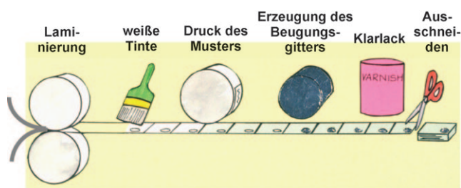
Abbildung 13. Prinzip des letztendlich eingesetzten Produktionsverfahrens für Plastikgeldscheine.
